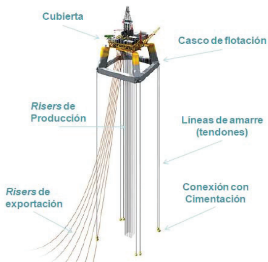
Figura 1. Componentes principales de un sistema flotante.
